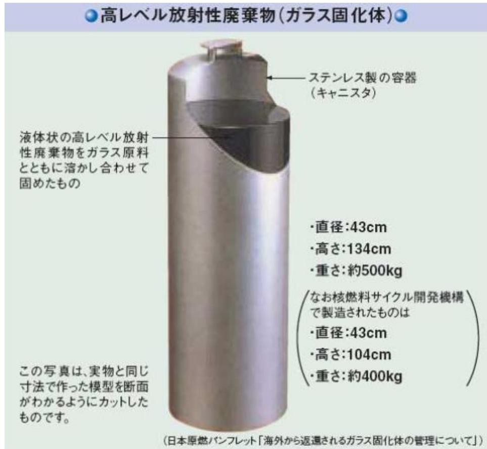
再処理の際に生じる放射能レベルの高い廃液を高温のガラスと溶かし合わせて固体化したものを30年から50年地上で空冷したうえで、地層処分(300m以上の深地下)。現時点で2.5万本相当の使用済燃料等
