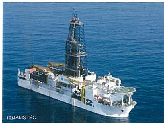
下北太平洋沖海上ボーリング調査に用いた地球深部探査船「ちきゅう」
