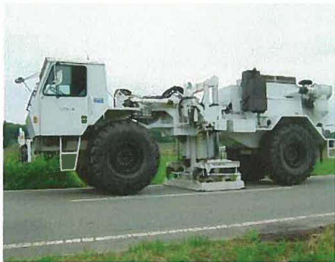
起振車により人工的に弾性波を発生させている様子
